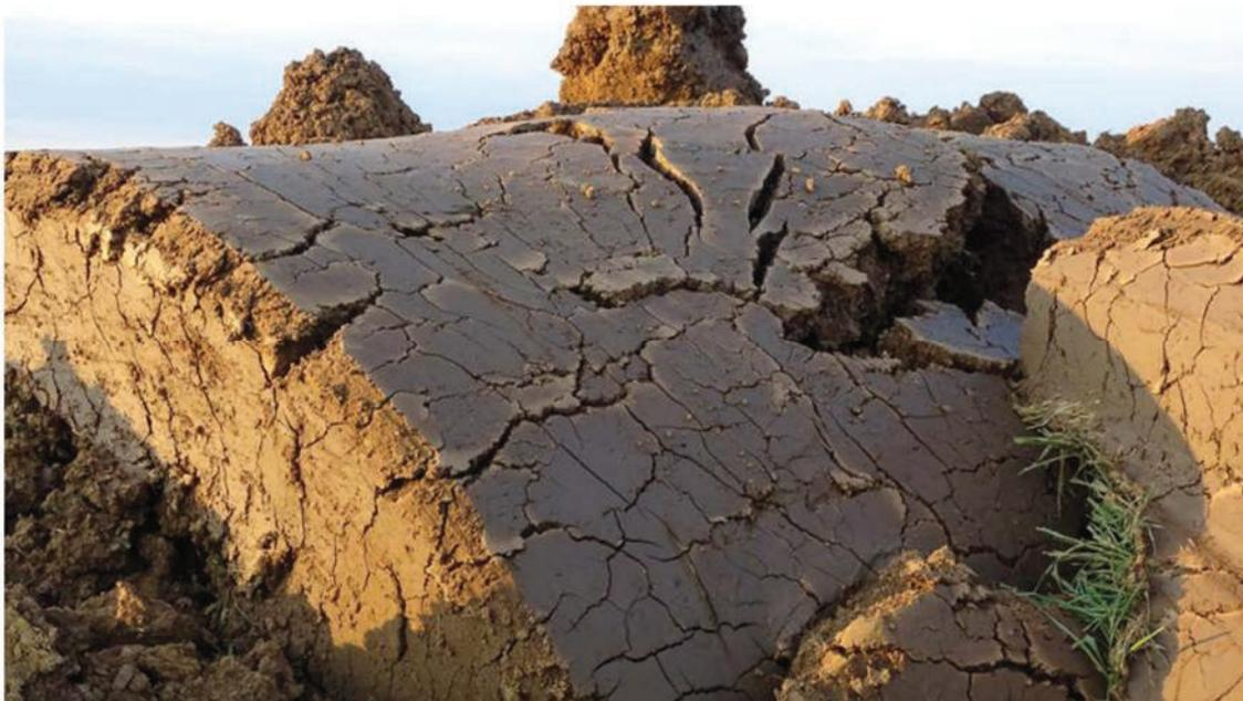
Abbildung 6: Walzenbildung und Gefügeschädigung durch schiebenden Abtrag bei Nässe [14]
